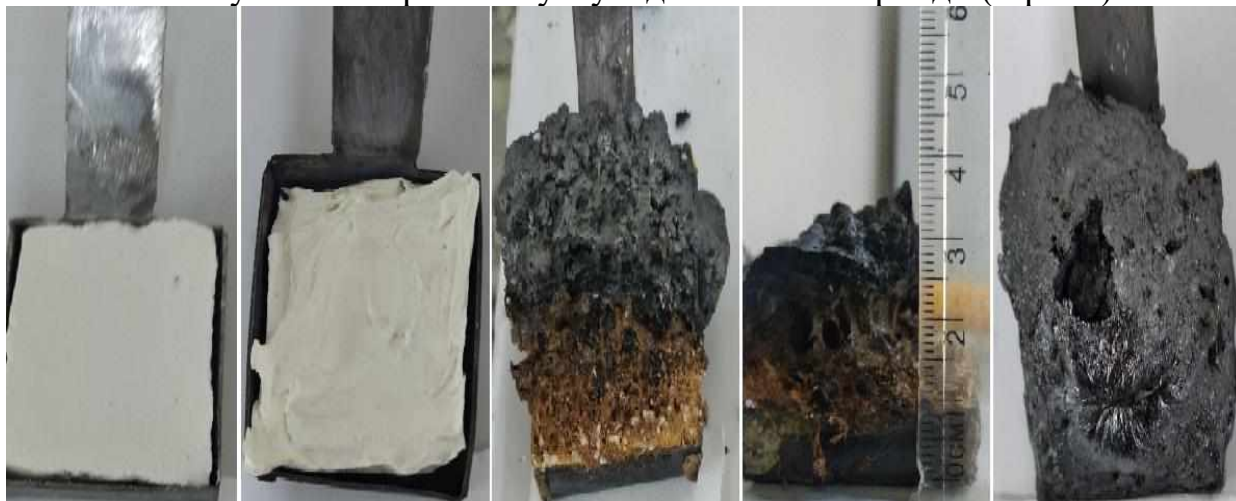
1-расм. Акрил сополимер асосидаги полимер композит материалларнинг ҳарорат таъсирида қавариқланиши.
