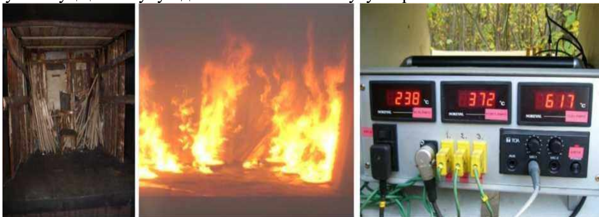
4-расм. Ёнғин симуляторида машғулотлар пайтида ёниш юки, унинг ёниши ва ҳароратни назорат қилиш
