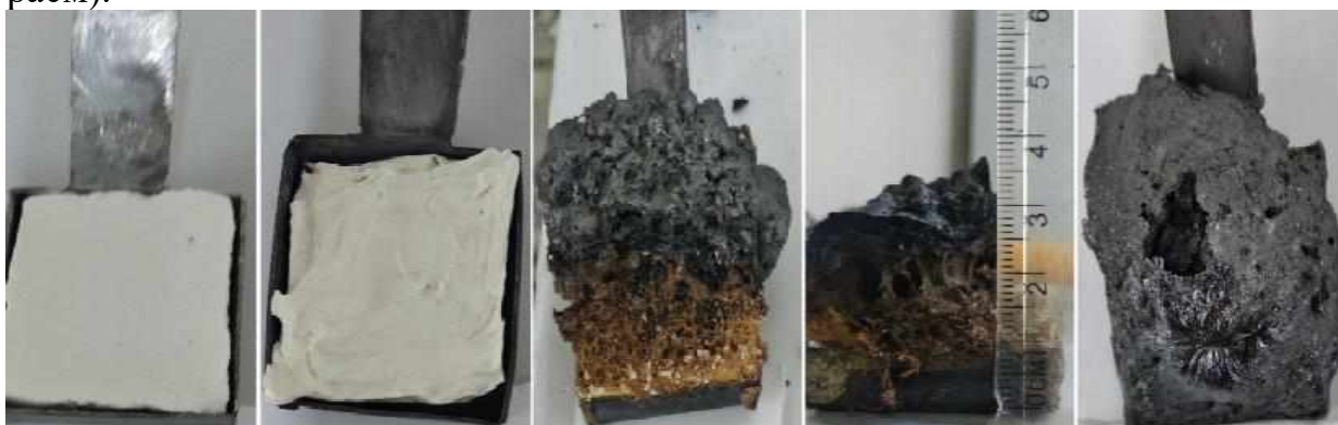
1 – расм. Акрил сополимер асосидаги полимер композит материалларни ҳарорат таъсирида қавариқланиши
